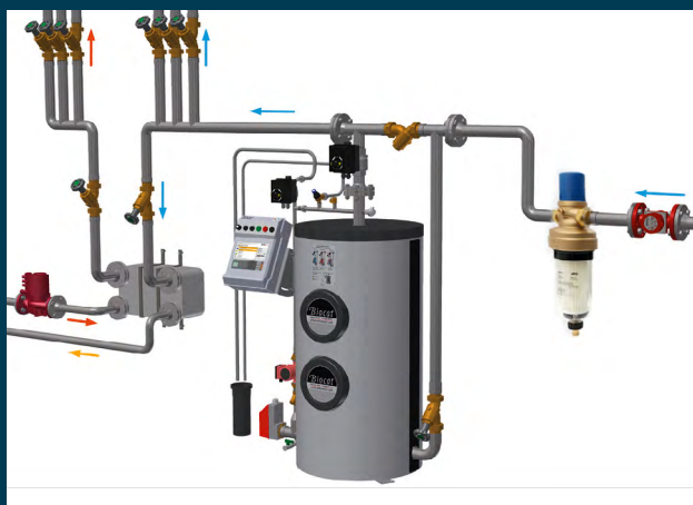
Schematische Darstellung einer Trinkwasser-Installation mit BIOCAT 14000
